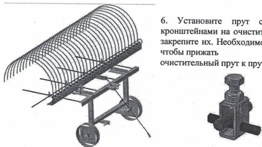
**I. Транспортное положение.** Болт транспортного положения фиксирует грабельный брус относительно рамы в неподвижном состоянии.
