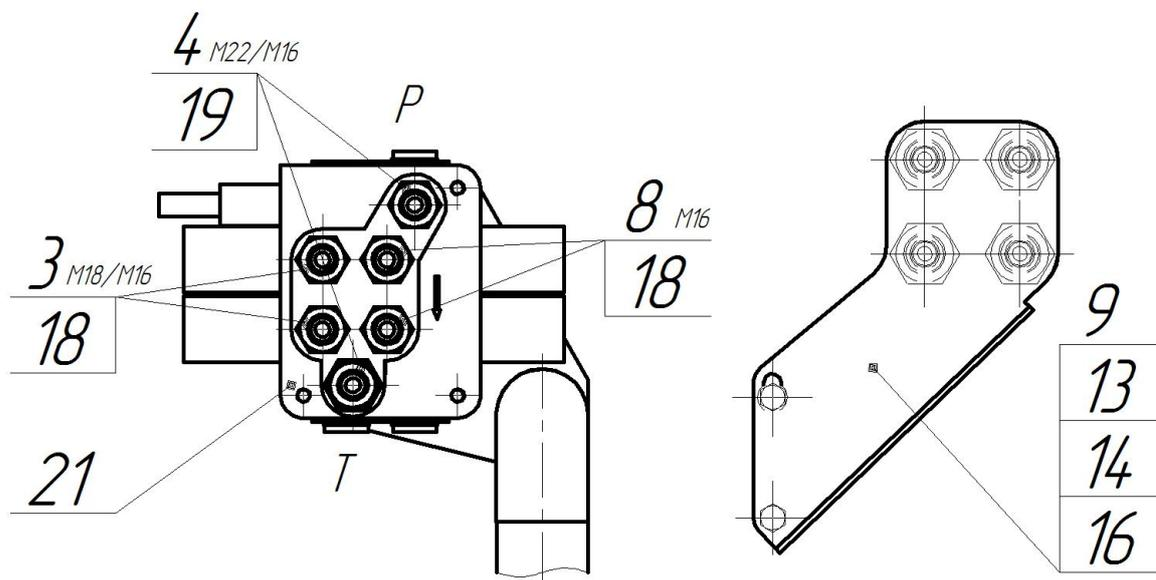
7.Кронштейн поз.10 задней розетки крепить к заднему правому крылу, предварительно просверлив в нем отверстия для крепления.
