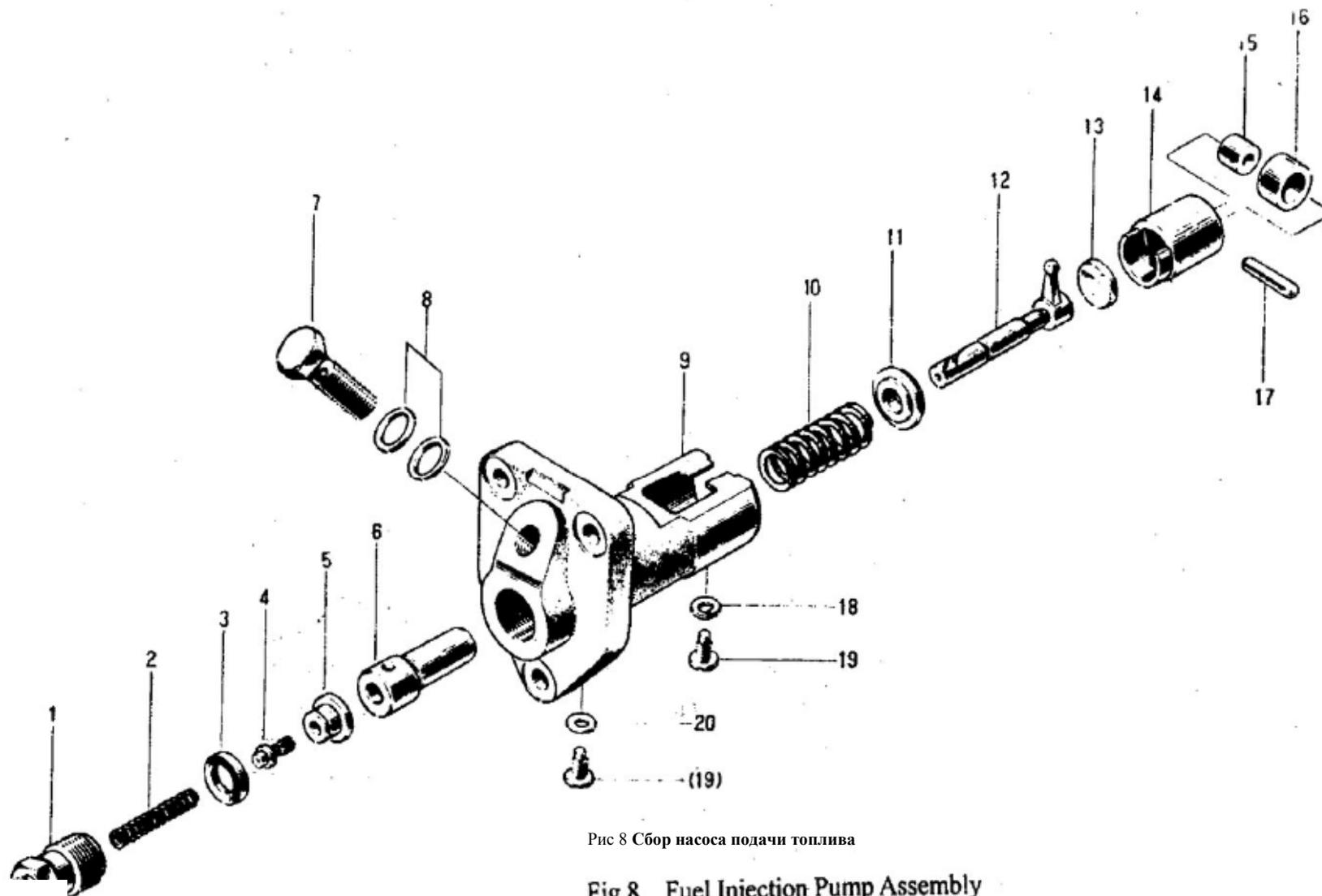
Рис 8 Сбор насоса подачи топлива
