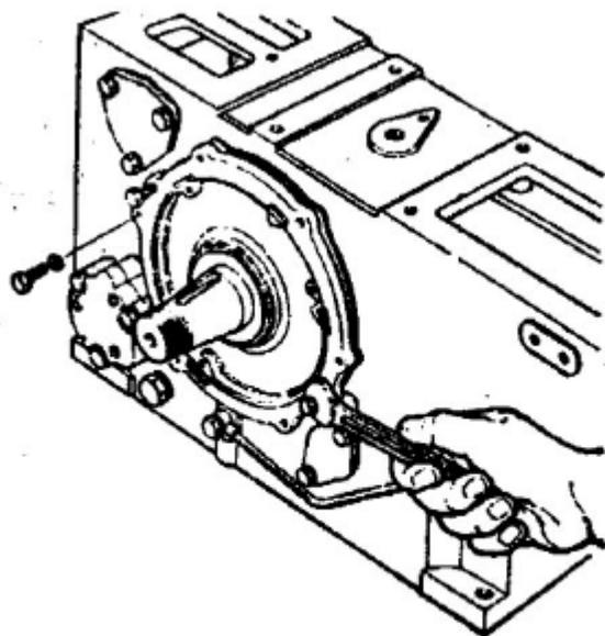
Рис 12 Снимите основной крышку подшипника
