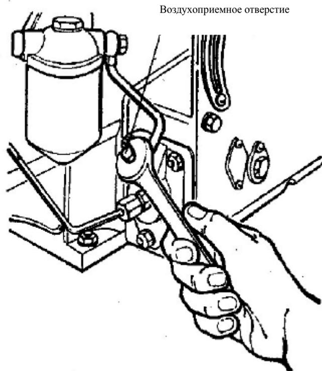
Рис 2 Выпуск воздуха из топливного трубопровода
