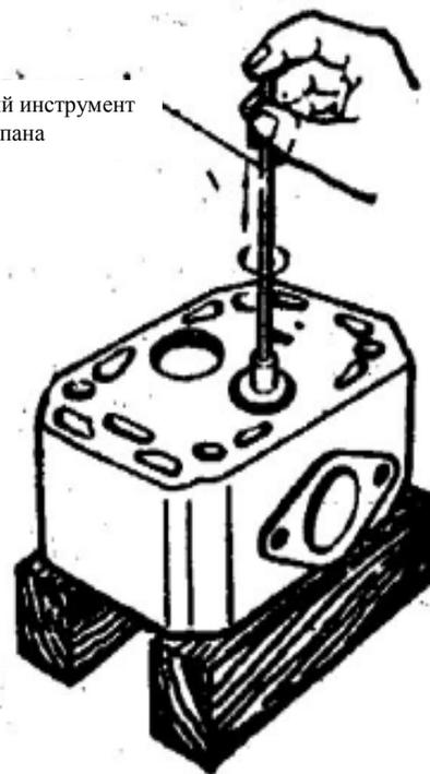
Рис 21 Закрутите клапана
