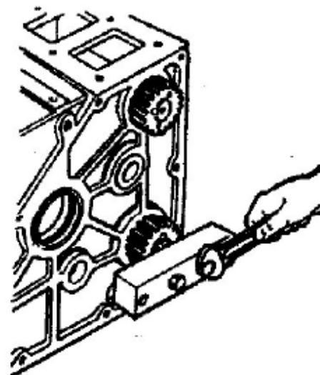
Рис 19 Вытащите привод балансировочного вала с помощью клещей
