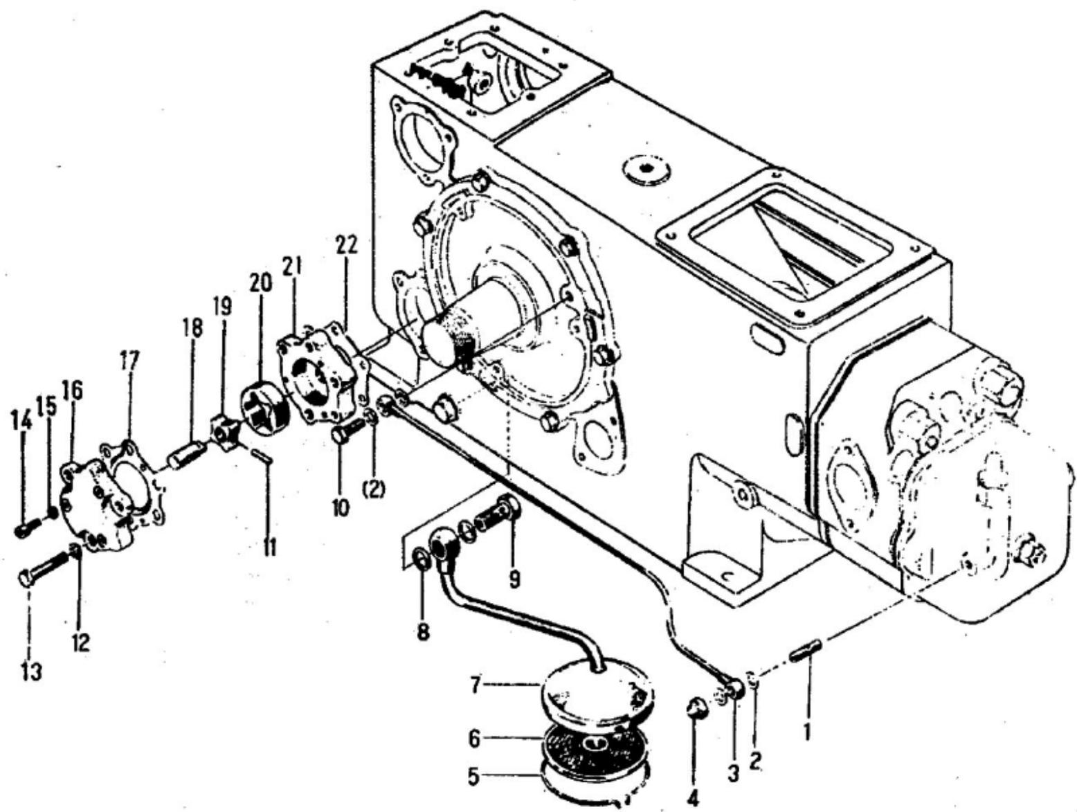
Рис 8 Система смазки
