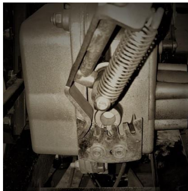
Рисунок 5.1 Фиксирующая пластина ручки КПП
